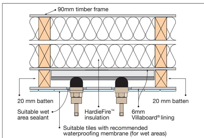
FIGURE 9 HARDIESMART™ AGED CARE WALL SYSTEM PLUMBING PIPE PENETRATION - PLAN
